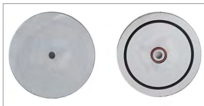
Bild 7: Aluminium-Druckguss-Prüfkörper mit der Legierung AlSi12 (Fe) und AntiCorr®-Schicht (nach 720 Stunden Salzsprühtest gemäß DIN ISO 9227) (Bild: Plasmatrete GmbH)
