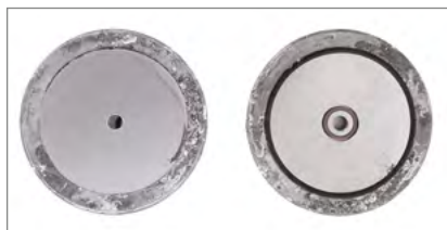
Bild 6: Aluminium-Druckguss-Prüfkörper mit der Legierung AlSi12 (Fe) ohne AntiCorr®-Schicht (nach 720 h Salzsprühtest gemäß DIN ISO 9227) (Bild: Plasmatrete GmbH)
