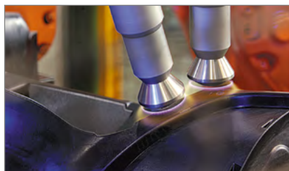
Bild 3: Durch die Aktivierung der Kunststoffoberfläche mit Plasma wird die Oberflächenenergie ( \text{mJ}/\text{m}^2 ) des Festkörpers erhöht und für den nachfolgenden Klebprozess im Hinblick auf die Haftungseigenschaften optimiert (Bild: Plasmatreat GmbH)
