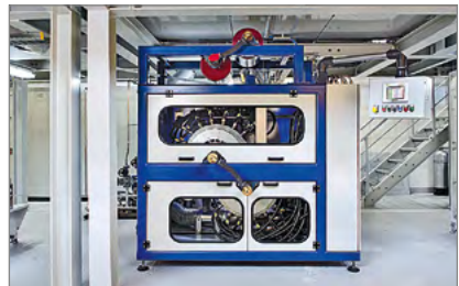
Bild 2: Eine kompakte, computergesteuerte Plasmaanlage ersetzt eine chemische Reinigungsstraße von Aluminiumbändern (Bild: Plasmatreteat GmbH)
