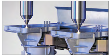
Bild 8: Die AntiCorr-Beschichtung wird bei einem Motor-Pumpen-Aggregat aus Aluminium-Druckguss eingesetzt. Die Dichtkontur der Aluminium-Bauteiloberflächen werden zunächst mit Openair-Plasma gereinigt und im Anschluss selektiv im Inline-Prozess beschichtet
